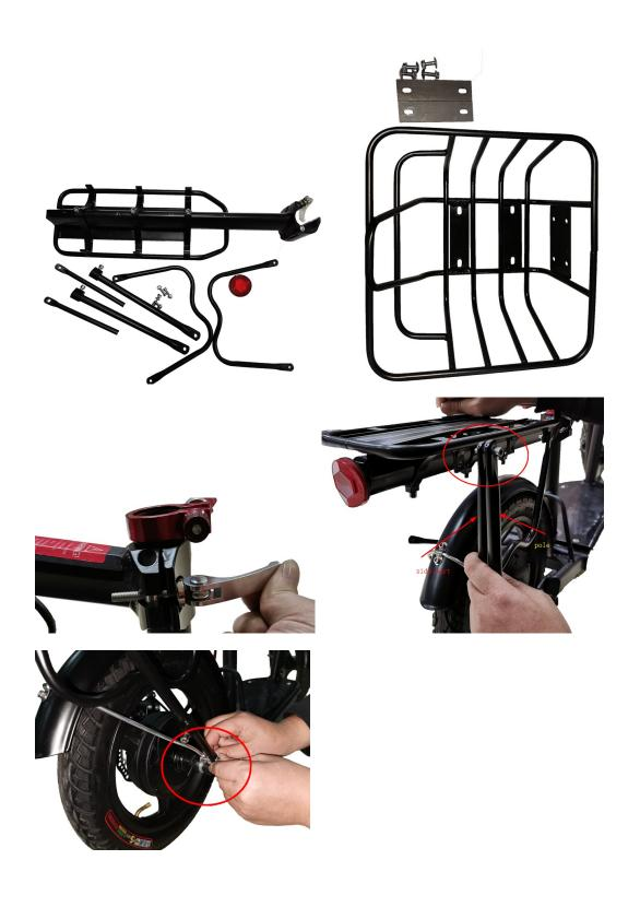
▲ 减震款后置物架安装,其他都是相同,只是把侧支架连接到座架的前螺丝孔,并固定到车架。具体参照图片。
